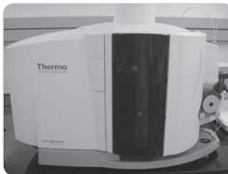
**Figura 3.9.** Espectrómetro de emisión empleado en la determinación de metales. (Este equipo se encontraba provisto de un automuestreador ASX-260 con capacidad para inyectar hasta 120 muestras en una misma secuencia de análisis).
