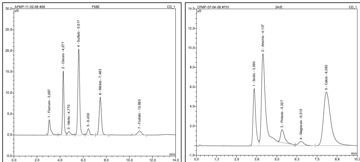
Figura 4.6. Cromatogramas típicos para muestras de PM<sub>10</sub>: a) Resultados para aniones; b) Resultados para cationes.
