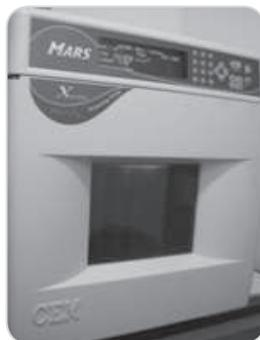
**Figura 3.8.** Equipo de microondas para la extracción de metales en los filtros.
