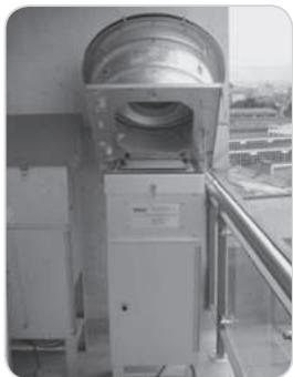
**Figura 3.5.** Muestreador de alto volumen empleado en la determinación de PM<sub>2.5</sub>.
