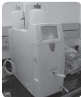
**Figura 3.7.** Cromatógrafo iónico Dionex ICS-2000.
